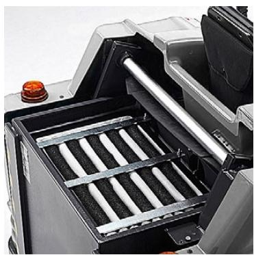
È una speciale struttura multitasca dalla grande superficie filtrante. Con un grado di filtrazione fino al 99,9% garantisce un'eccezionale qualità dell'aria scaricata nell'ambiente, costante nel tempo. Tra le sue ulteriori caratteristiche: è lavabile, resistente ad acqua e olio, autopulente e di facile mantenimento.
