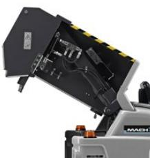
Il contenitore dei rifiuti, a scarico multi-livello, è dotato di portellone di apertura/chiusura a controllo idraulico. È situato sulla parte posteriore, ha una capienza di 150 litri e può essere sollevato idraulicamente da terra sino a 1350 mm di altezza.
