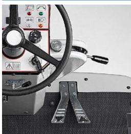
MACH 5 monta un potente sistema di trazione, a velocità variabile fino a 9 Km/h, governato per mezzo di bi-pedali (marcia avanti e indietro).
