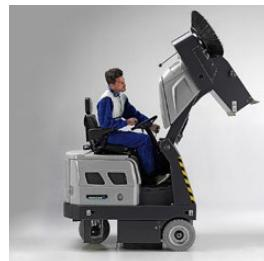
Il cassetto rifiuti è posizionato frontalmente e può essere sollevato idraulicamente fino a 1.565 mm dal suolo. Il cassetto è flottante e si regola automaticamente, permettendo una raccolta molto semplice dei detriti più voluminosi.
