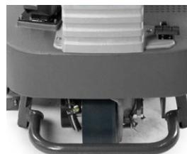
Il motore di trazione è sigillato e protetto da un robusto paracolpi tubolare in acciaio che integra in sé anche il dispositivo antiribaltamento. La gomma della motoruota è in poliuretano antitraccia e antiskid.
