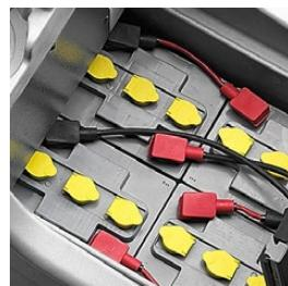
Grazie all'ottimizzazione del consumo di energia, le batterie delle macchine lavasciuga M650/M750/M830 consentono un'autonomia operativa interrotta di 4 ore. Il pratico carica batteria a bordo ne garantisce il ciclo di ricarica ottimale.
