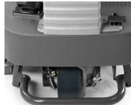
El motor de tracción está sellado y protegido por un robusto parachoques de acero, que cuenta asimismo con un dispositivo anti-vuelco. El neumático de la rueda motriz está fabricado en poliuretano antideslizante y no deja huellas.
