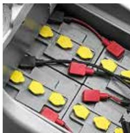
Gracias a la optimización del consumo de energía, las baterías de la M650/M750/M830 pueden operar durante 4 horas de manera ininterrumpida. El práctico cargador integrado garantiza un ciclo de carga eficiente.
