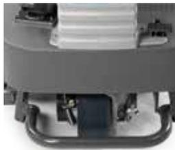
El motor de tracción está sellado y protegido por un robusto parachoques de acero, que cuenta asimismo con un dispositivo anti-vuelco. El neumático de la rueda motriz está fabricado en poliuretano antideslizante y no deja huellas.
