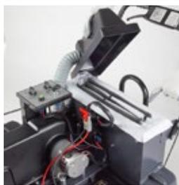
El polvo fino se filtra a través de un filtro de bolsa de poliéster, con un grado de filtración del 99,9%. Este filtro tiene una vida útil mucho más larga que un filtro tradicional y puede ser fácilmente limpiado a través del sacudidor mecánico incorporado.
