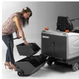
Situado en la parte trasera de la máquina, el contenedor de residuos cuenta con una capacidad de carga de 63 litros (83 kg). Fabricado en acero, está montado sobre ruedas y equipado con un asa cómoda para facilitar su transporte y vaciado. Los cajones extraíbles opcionales facilitan aún más la tarea de vaciado del depósito.
