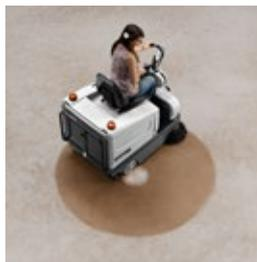
La barredora compacta MACH 2 tiene un radio de giro reducido (950mm), lo que permite la limpieza de espacios estrechos de difícil acceso.
