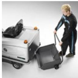
El depósito de 85L es uno de los principales puntos fuertes de la MACH 3 PRO, permitiendo a la barredora trabajar más tiempo antes de tener que parar para vaciar el depósito. Los cajones reductores opcionales facilitan el proceso de vaciado.
