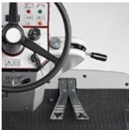
La MACH 5 posee un sistema de tracción muy potente y una velocidad máxima de 9 km/h. Esto se controla a través de un doble pedal (para marcha adelante y atrás).
