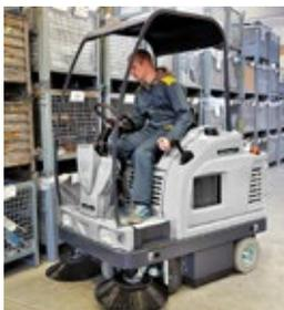
Para una seguridad y confort máximos para el operador, la MACH 5 puede ser equipada con una variedad de accesorios: kit de iluminación completo, señal acústica de marcha atrás, techo de protección, parabrisas en policarbonato, faros giratorios (estándar en la UE), filtro de cartuchos de categoría M.
