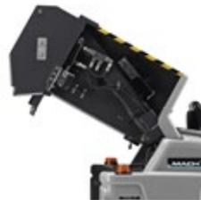
El contenedor de residuos con sistema de descarga multi-nivel está equipado con una puerta controlada hidráulicamente. El depósito está localizado en la parte trasera de la máquina y posee una capacidad de 150L, puede elevarse hidráulicamente a una altura máxima de 1350mm.
