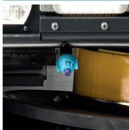
Le spazzole laterali di MACH 8 possono essere dotate di nebulizzatori per abbattere le polveri.
