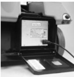
Dos baterías de 12V proporcionan 2 horas y 10 minutos de uso continuo con cada ciclo de recarga. El cargador incorporado está protegido en una carcasa de acero y es de fácil acceso.
