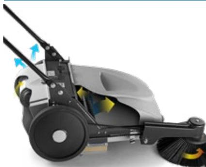
La ruota laterale della spazzatrice, oltre ad attivare la spazzola centrale per la raccolta dei detriti, fa girare velocemente un albero trasmissione collegato ad una ventola che, grazie al rapporto dei diametri (ruota-albero trasmissione), aspira tutta la polvere e la convoglia verso l'apposito filtro. Il sistema integra in una spazzatrice manuale un efficiente sistema di aspirazione/filtrazione che non necessita di motorizzazioni, in modo da garantire semplicità, economia ed ecologia.
