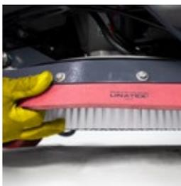
Il piatto spazzole in acciaio INOX ospita due spazzole per una pista complessiva di pulizia di 1.000 mm. Garantisce produttività incomparabile.
