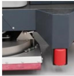
El chasis, fabricado con acero, proporciona protección tanto al operador como a las partes internas de la máquina. Se puede añadir opcionalmente un tejadillo de protección a la M1100-D para una seguridad reforzada.
