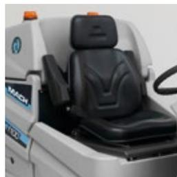
El asiento del operador está equipado con sensores de peso y un cinturón de seguridad. También es posible cortar la energía en caso de emergencia o durante operaciones de mantenimiento, garantizando una protección y una seguridad máximas para los operadores y mecánicos.
