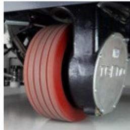
Potente y fiable, el motor de tracción está instalado verticalmente en la parte frontal de la máquina. La rueda frontal es accionada a través de una caja de engranajes que se encuentra lubricada y sellada para protegerla contra impactos, suciedad y humedad.
